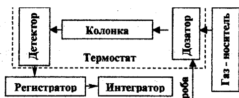
Рис.3.6.1. Блок-схема газового хроматографа.
