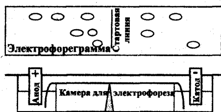
Рис 3.5.1. Схема прибора для электрофореза.
